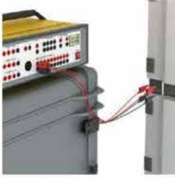
3.1 Test ekipmanı, çap 4mm test fişleri ile donatılmıştır.
